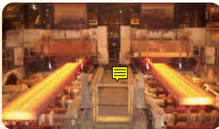
Lubrification de trains à brame
